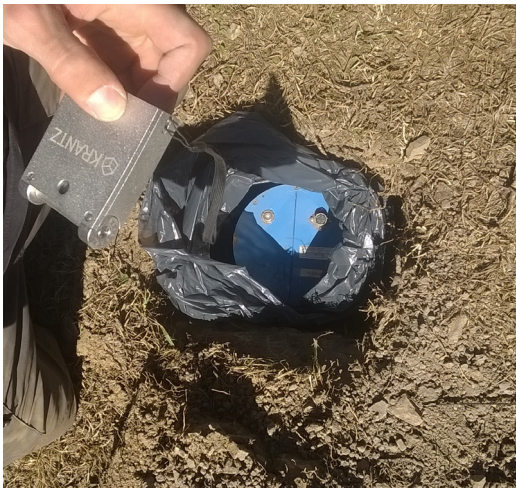
Elementos de una de las estaciones sísmicas instalada en el valle de Lerma. La red se compuso de 12 estaciones que funcionaron entre agosto de 2017 y setiembre de 2018. Izquierda: vista del sismómetro enterrado; derecha: panel solar que recarga una batería la cual alimenta de energía al sismómetro
