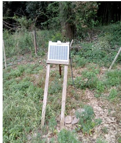
Elementos de una de las estaciones sísmicas instalada en el valle de Lerma. La red se compuso de 12 estaciones que funcionaron entre agosto de 2017 y setiembre de 2018. Izquierda: vista del sismómetro enterrado; derecha: panel solar que recarga una batería la cual alimenta de energía al sismómetro
