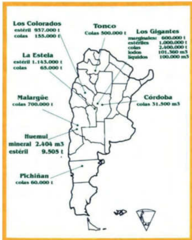
Figura 1. Mapa de localización de las 8 minas de Uranio abandonadas de la CNEA. Debajo de la denominación de cada mina se detallan la cantidad y tipo de residuos que no han sido tratados y dispuestos de manera adecuada.
