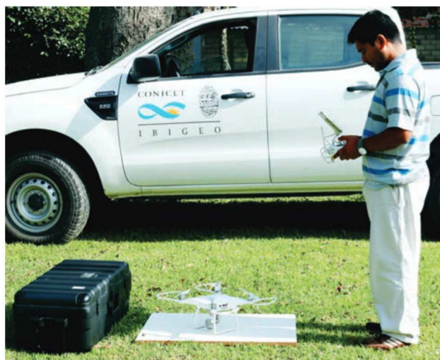
Comprobación de señal GPS y plan de vuelo previo a tareas de relevamiento.
