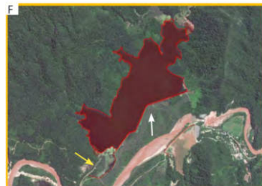
F El 20/8/2019 la superficie del vaso es de 87 ha, un 22% de la superficie original; esta se preserva debido a las defensas realizadas (flecha blanca) que evitan el ingreso del río; se realizó también una toma hacia agua arriba y un canal de aducción (flecha amarilla).
