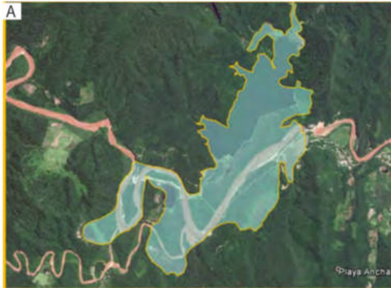
A Superficie original del vaso en 1970, 390 ha, materializada a partir de un plano conforme a obra sobre una imagen Google del corriente año.
