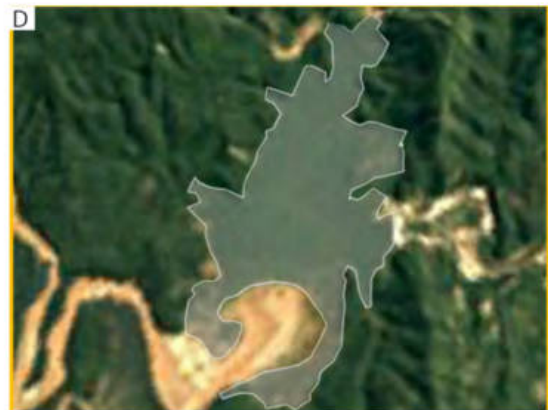
D La deposición de sedimentos en la cola del vaso el 30/12/1989 redujo su superficie a 194 ha que representa una pérdida del 51% respecto de la superficie original.
