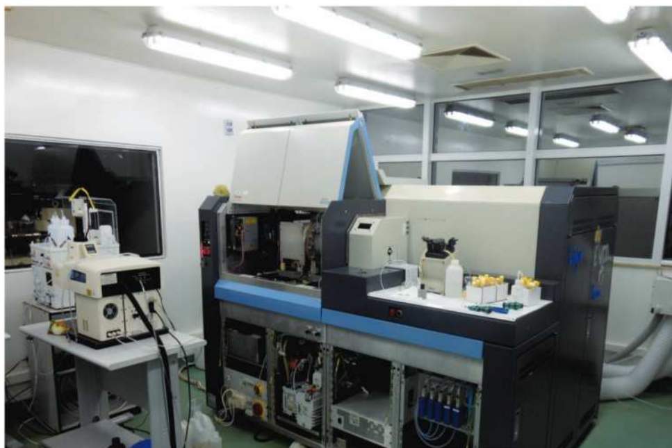
Figura 7. Espectrómetro de masa (LAICPMS) del Laboratorio de Geocronología de la Universidad de Brasilia, Brasil.
