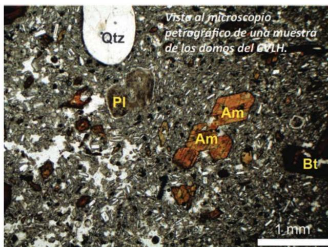
Vista al microscopio petrográfico de una muestra de los domos del CVLH.
