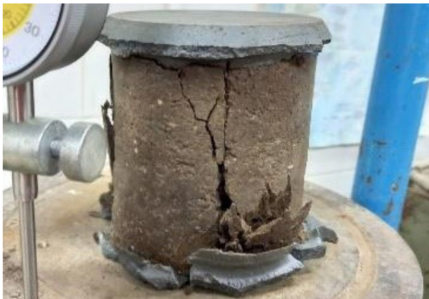
Fig. 3: Muestra ensayada a compresión
