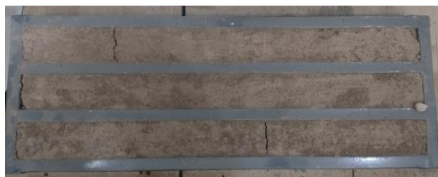
Fig. 7: Probetas del ensayo de contracción lineal
