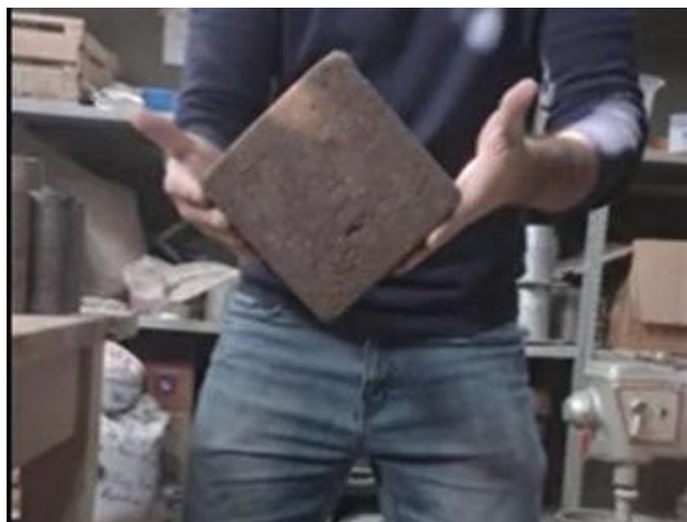
Fig. 6: Ensayo de caída de ladrillo completo
