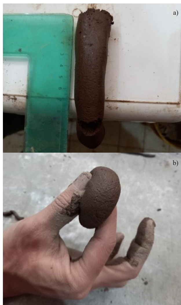
Fig. 2: Ensayos de aptitud del suelo para materializar un muro tapial. a) Ensayo de cinta de barro. b) Ensayo de resistencia seca.
