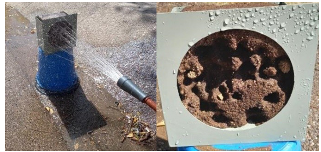
Fig. 4: Erosión húmeda. a) ejecución del ensayo. b) muestra ensayada
