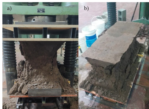
Fig. 8: Bloque de muro tapial ensayado en compresión simple con detalle de la rotura obtenida
