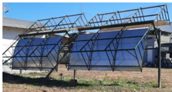
Fig 3. Estructura de soporte de superficies reflectoras de ambos módulos, ancladas al suelo mediante ejes de rotación y rodamientos.
