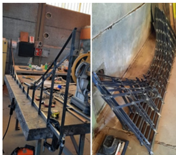
Fig 2. Izq. Confección de soporte para superficie reflectora (costillas). Der. Set de costillas para un módulo de 5.5 m 2 .
