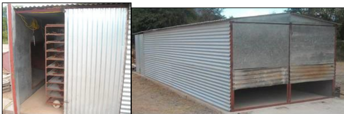
Fig. 6: Cámara de secado. Puerta lateral (izquierda) y portón frontal (derecha)
