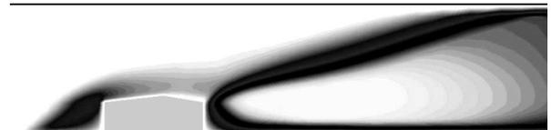
Fig. 2. Energía cinética turbulenta, modelo  $k - \omega$
