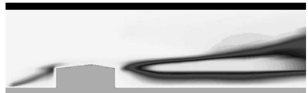
Fig. 1. Energía cinética turbulenta, modelo  $k - \varepsilon$
