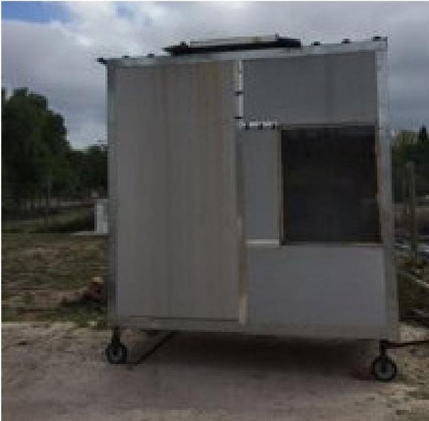
Fig. 2. Imagen de sistema de enfriamiento radiante pasivo –SERA-
