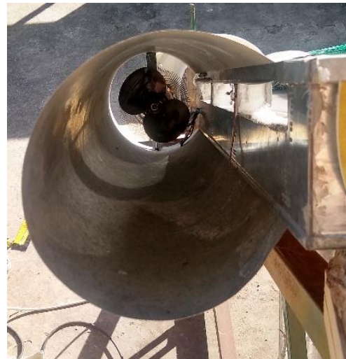
Fig. 9: Método de aumento de la temperatura de entrada al colector mediante calientador.
