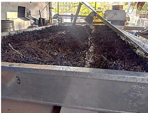
Fig. 4: Viruta reciclada distribuida en el colector.
