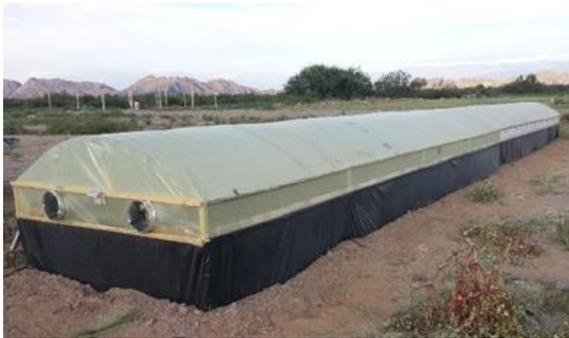
Fig. 5. Secadero solar tipo túnel ('secadero túnel')
