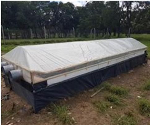
Fig 6. Secadero solar tipo túnel con recirculación ('secadero túnel').
