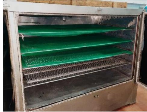
Fig. 8. Estufa de secado de laboratorio.
