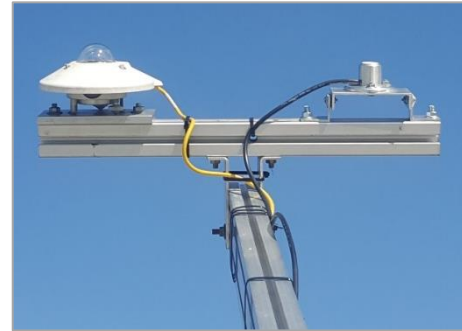
Fig. 2: A la izquierda se observa el instrumento de Kipp & Zonen y a la derecha el desarrollado por el DES.
