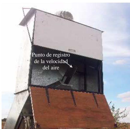
Fig. 5. Dispositivo de recolección del aire a la salida del colector
