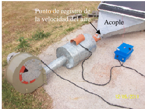
Fig. 3. Ingreso del flujo de aire al colector
