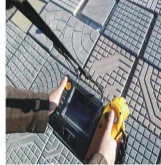
Fig. 5: Evaluación térmica con la cámara IR Fluke Ti 55.
