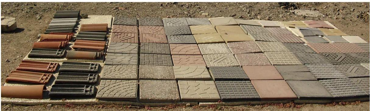
Fig. 3: Evaluación térmica y óptica de los materiales en el predio.
