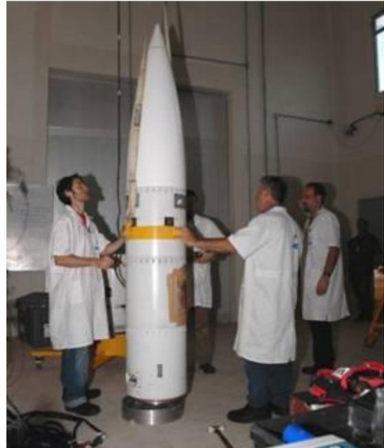
Fig. 4. Cofia del cohete VS-30. Arriba de la faja amarilla se observan dos de los cinco soportes de sensores apareados.
