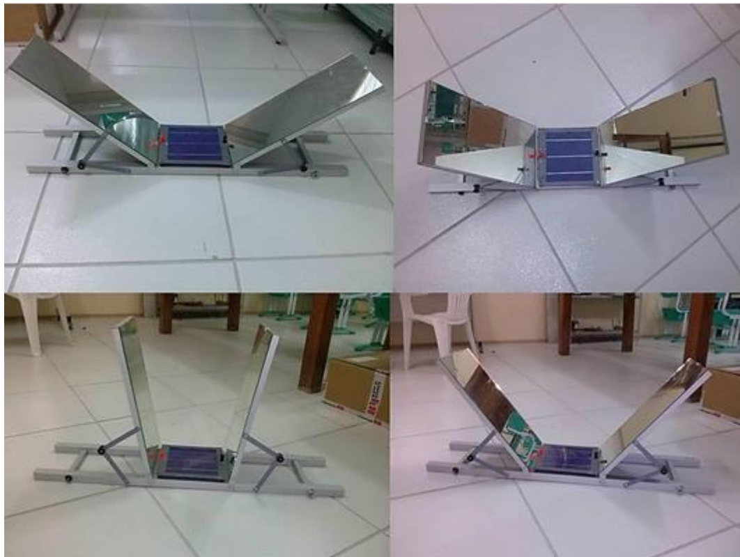
Fig. 1: Concentrador solar tipo V desenvolvido.
