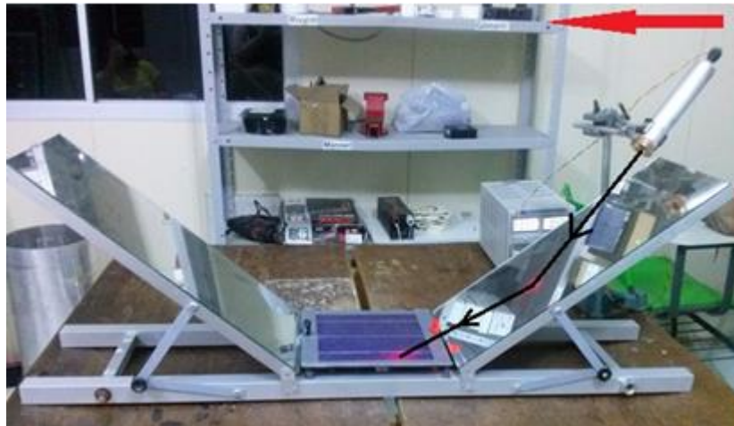
Fig. 3 – Determinação experimental da função de aceitação angular.
