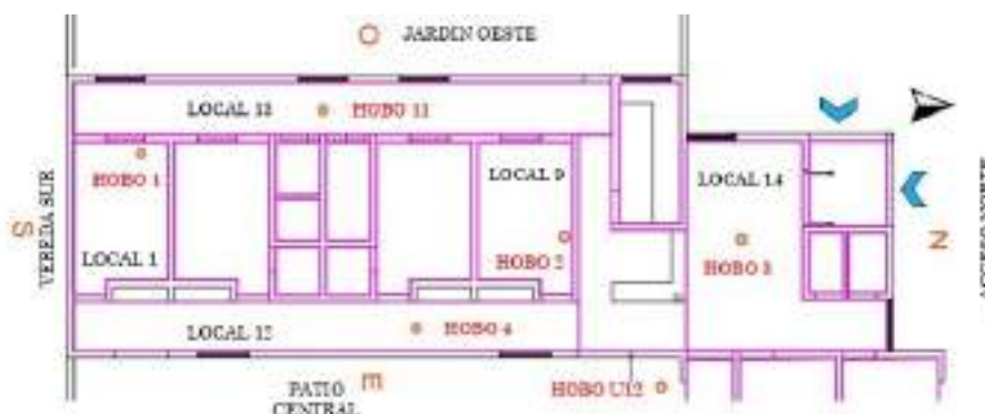
Figura 4: Planta ubicación sensores en locales área Salud
