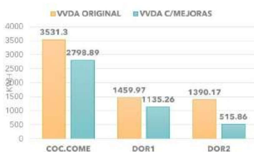
Figura 11: Carga de refrigeración - comparación.
