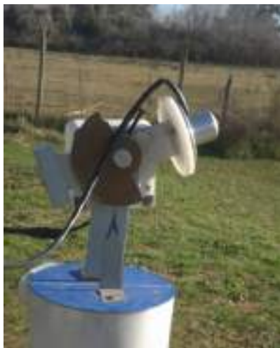
Figura 2: fotografía del trackeador, ya instalado.
