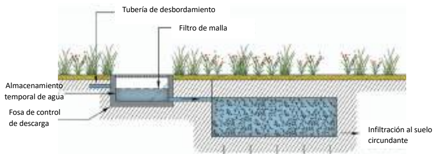
Figura 12: Sistema de infiltración tipo fosa de absorción rellena de grava. Fuente: Manual Procedimientos de Ingeniería del WSUD para Aguas Pluviales, Melbourne Water y CSIRO-2005.
