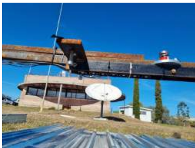
Figura 1: Arreglo experimental: siete LI-200 orientados hacia abajo, separados 3 cm y montados a 30 cm sobre la chapa; la línea de sensores cruza de cresta a cresta. Dos chapas de 1 m en continuidad aseguran que el campo de visión esté dominado por la propia superficie.
