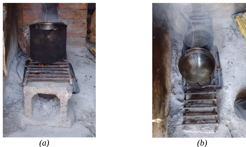
Figura 4: Ensayos en el fogón tradicional evaluado con dos ollas, (a) vista lateral, (b) vista superior.
