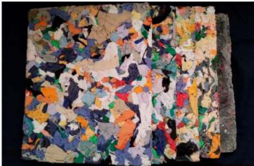
Figura 2: Placas aislantes de residuos textiles y almidón de papa.
