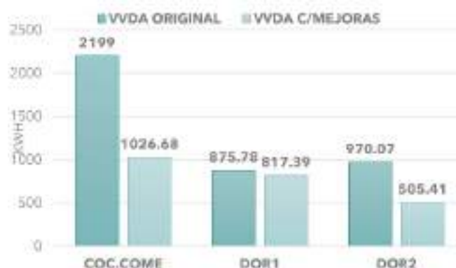
Figura 53: Carga de calefacción - comparación
