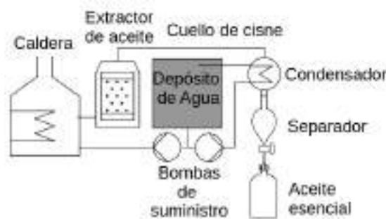
Figura 1: Esquema de la Planta de extracción de aceites PEM 100
