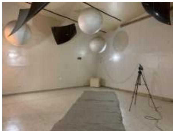
Figura 1: Ensayo en cámara reverberante del Laboratorio LAL-CIC de mantos de lana de oveja
