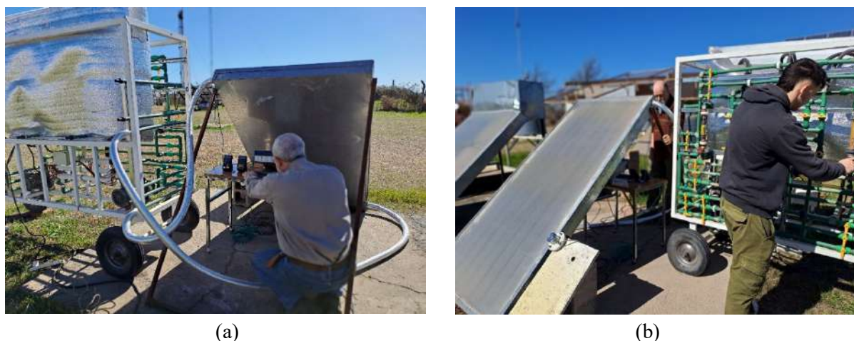
Figura 2: Realización del ensayo de eficiencia térmica instantánea del colector solar de placa plana.
