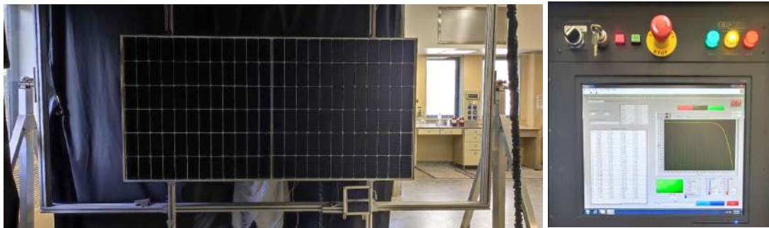
Figura 2: Equipamiento utilizado para ensayo de curva I-V de módulos FV.
