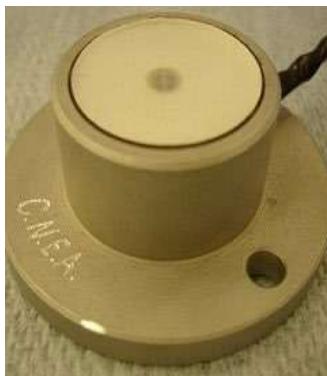
Figura 3: Piranómetro utilizado para la medición de radiación en el plano de los paneles. Tipo Radiómetro PAR de CNEA.
