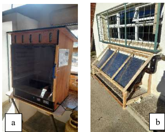
Figura 7a) Gabinete de deshidratado ubicado en interior de cocina del CEA N°3. 7b) Colector solar ubicado inmediatamente en el exterior.
