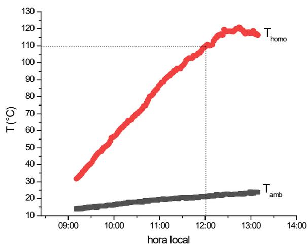
Figura 5. Evolución de temperatura en el interior del horno en un día de invierno.
