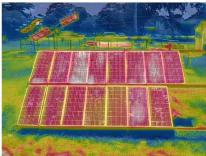
*Figura 6: Imagem IV frontal de módulos Photowatt® em série*
