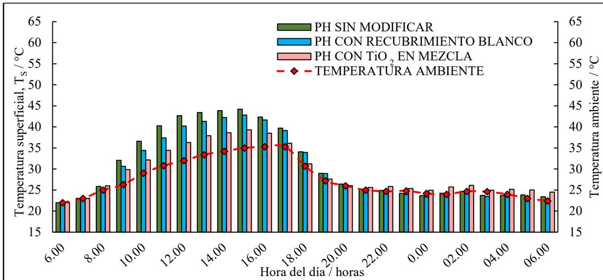
Figura 2b: Variación horaria de las temperaturas superficiales,  $T_s$ , de muestras de PH sin y con recubrimiento blanco o con  $TiO_2$  en su composición, todas expuestas un día completo al aire libre.
