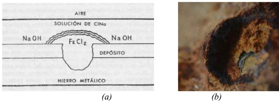
Figura 17 (a) Esquema de la corrosión localizada, extraída de Rosado, 2003
