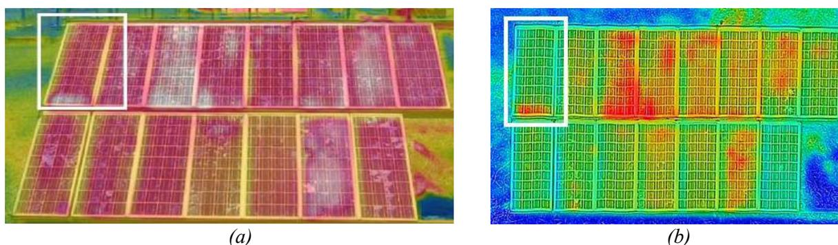
Figura 8: Comparação das imagens IV obtidas em solo e aéreo do arranjo Photowatt® em série, (a) termograma captado em solo do arranjo Photowatt® ligado em série, (b) termograma captado com o drone (destaque de módulo com quadrado na cor branca).
