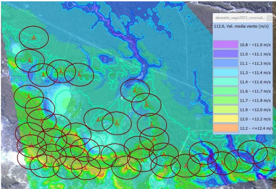
Figura 4: Parque 180 MW, aerogenerador Vestas V136 4.5 MW, altura buje 112 m. Se muestra mapa de velocidades medias y leyenda, en m/s. Fuente: Elaboración propia en WindPRO.
