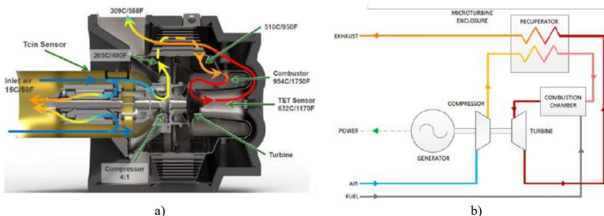
Figura 2. a) Corte transversal de la turbina con indicación de flujo de aire. b) Diagrama funcional simplificado. Microturbina Capstone Green Energy, modelo C65-GC. Fuente: Capstone (2021).
