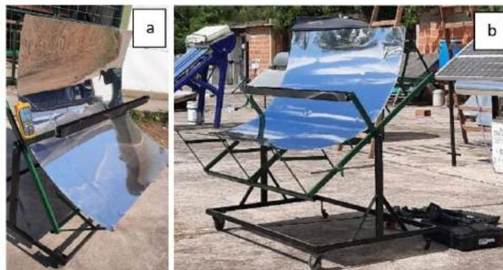
Figura 3. Concentrador cilindroparábolico construido y orientado hacia el sol.
