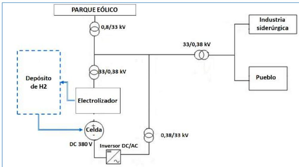
Figura 5: Esquema unifilar, simplificado, de las transmisiones eléctricas.
