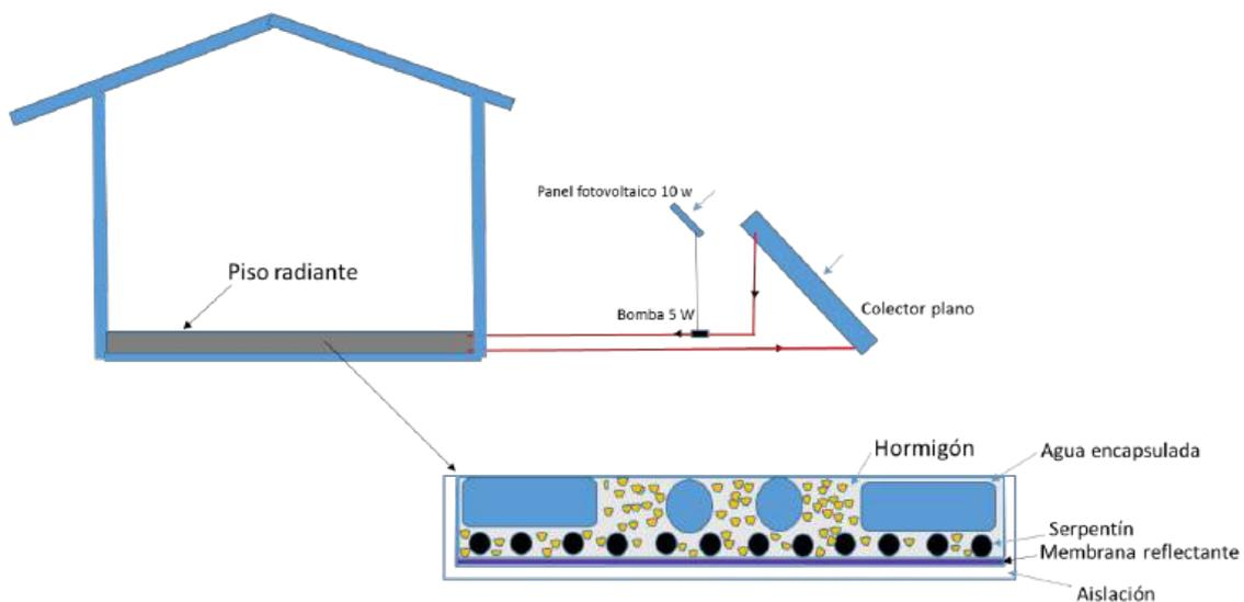
Figura 4. Esquema del piso radiante acumulador autónomo propuesto en este trabajo.
