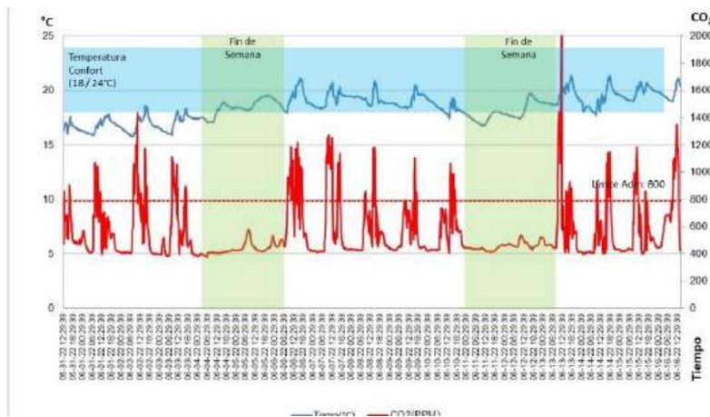
Aula de 5to en planta alta (Orientación NE). CO<sub>2</sub> período de medición
