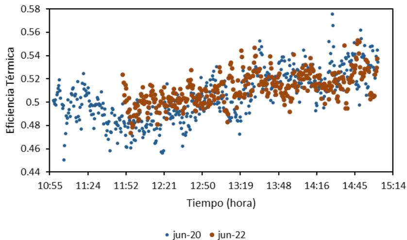
Figura 7: Eficiencia instantánea del colector prototipo en función del tiempo para dos ensayos con el mismo flujo másico del aire.
