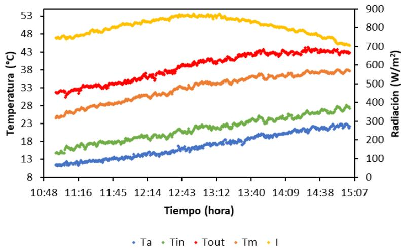
Figura 8: Temperatura ambiente, tres puntos del colector y radiación solar para el día 20/06, con filtro de radiación mayor a 600 W/m<sup>2</sup> y ángulo de incidencia 30°.
