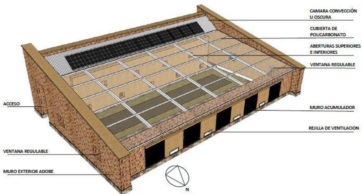
Figura 3. Axonometría del Invernadero proyectado.
