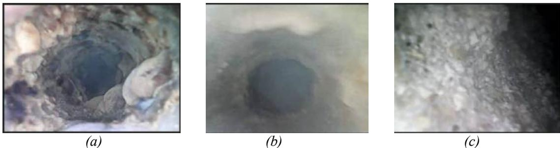
*Figura 10 CAI pa (a) Entrada de agua con sarro (b) Salida de agua sin sarro (c) Fondo del tanque.*
