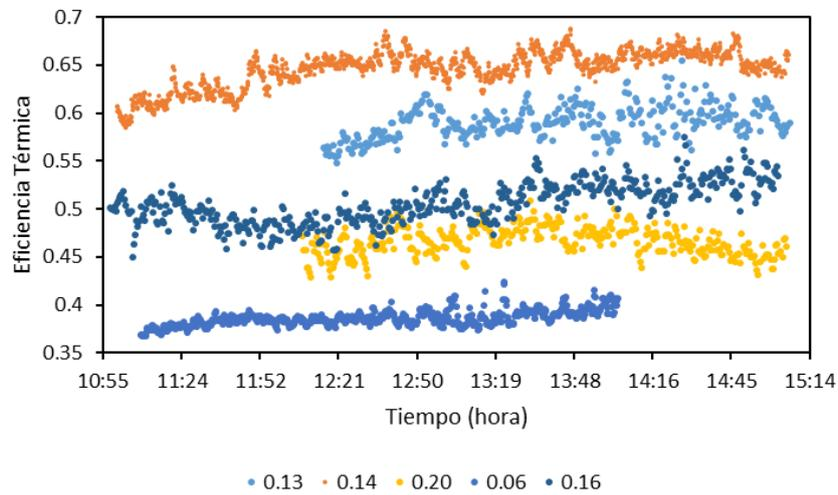
Figura 6: Eficiencia instantánea del colector prototipo en función del tiempo para ensayos con distintos flujos másicos del aire.
