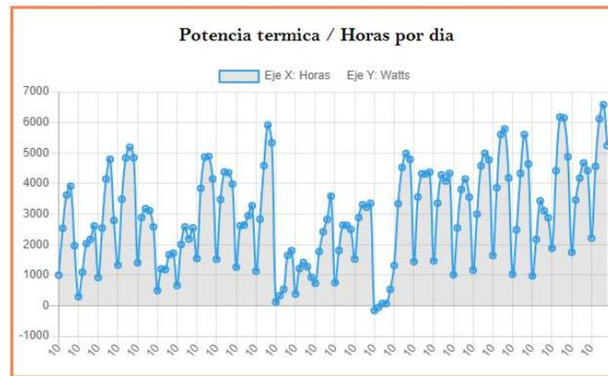
Figura 6: Resultados de potencia térmica para febrero de 2023. caudal másico de 0.01 kg/s.
