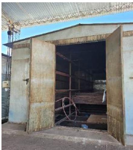
Figura 2: Vista del frente de carga y descarga de la estufa, se observan la estructura de rack para los cuatro niveles de peines.
