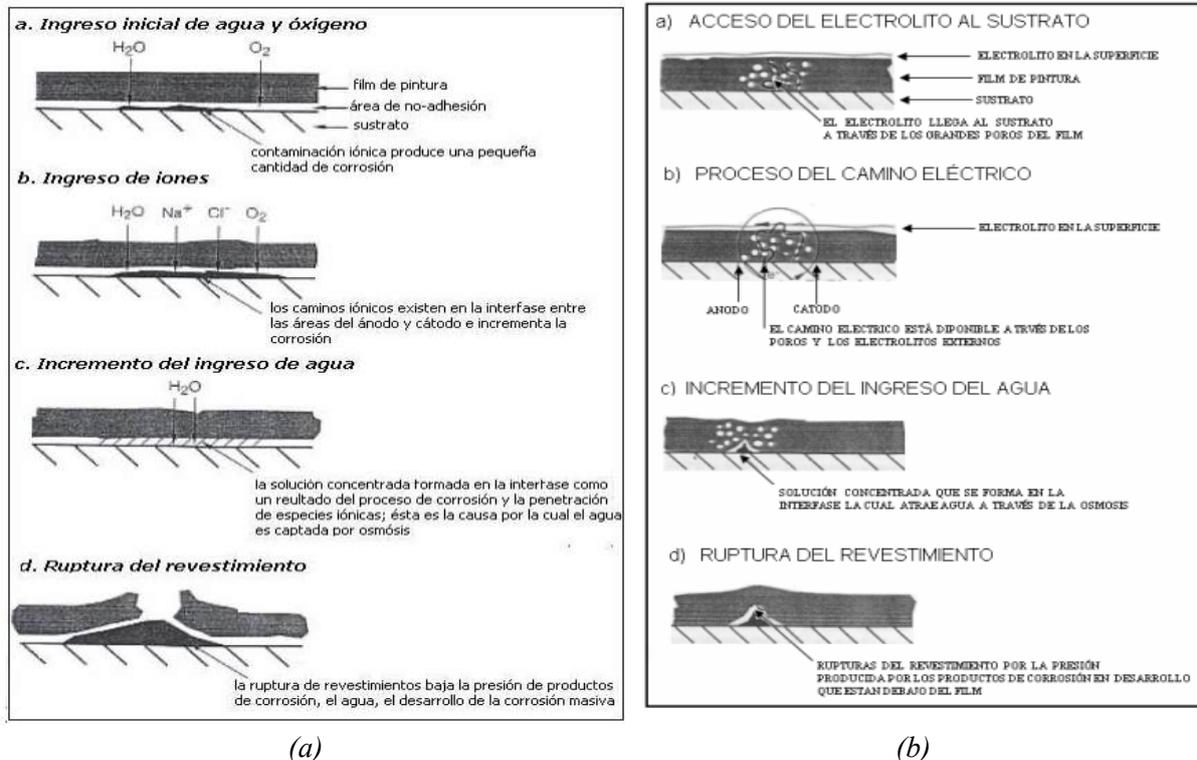
Figura 12: Mecanismo de corrosión en films, extraído de Navarrete Cueva, 2007
