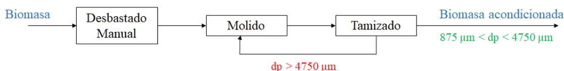
Figura 1: Esquema de acondicionamiento de biomasa.
