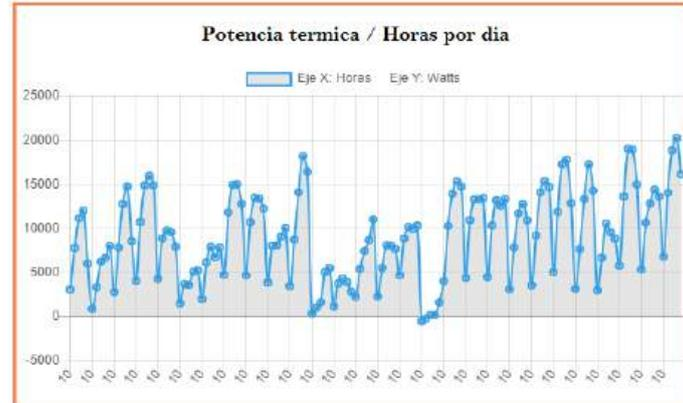
Figura 7: Resultados de potencia térmica para febrero de 2023. caudal másico de 0.05 kg/s.
