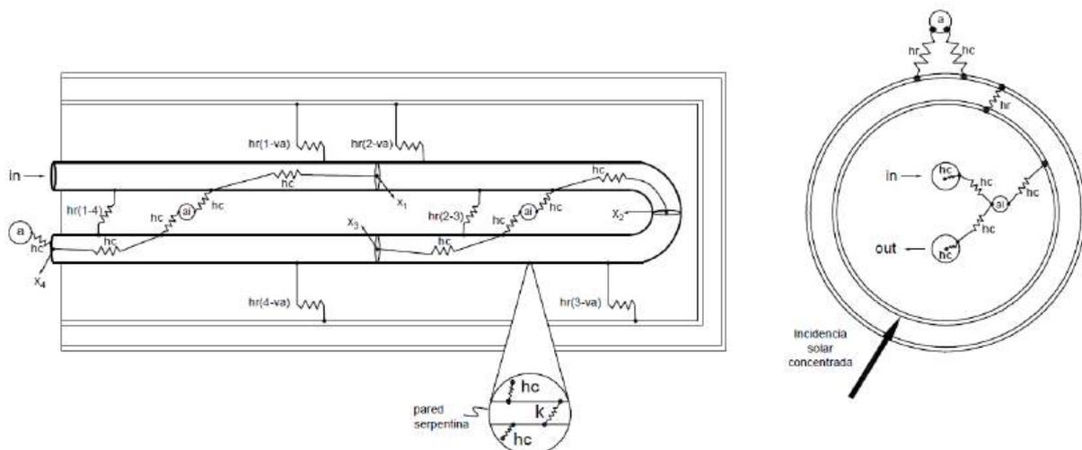
Figura 2: Modelo termofísico. Corte longitudinal (izq). Corte Transversal (der).
