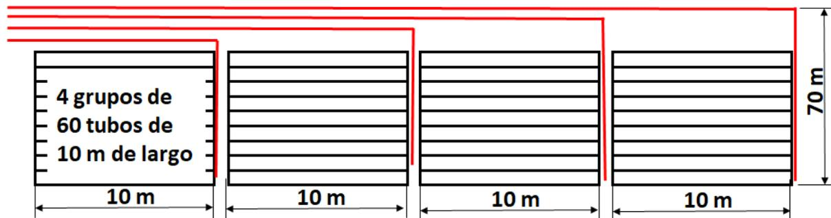
Figura 1: esquema de ubicación de los tanques de almacenamiento de H<sub>2</sub>. Esto representa en tamaño, un terreno de 45 m x 70 m, es decir 3150 m<sup>2</sup> de superficie, como mínimo. Elaboración propia.
