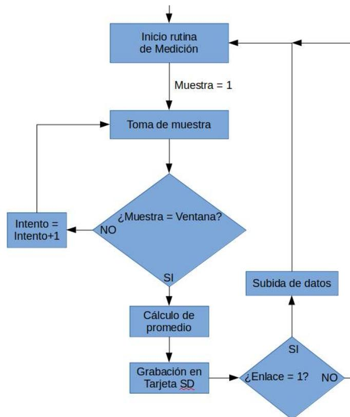
**Figura 2C:** Esquema del programa, rutina de medición, promedio, almacenamiento y subida de datos.
