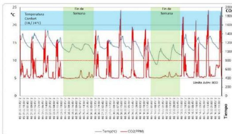
Aula de 6to en planta baja (Orientación NO). CO<sub>2</sub> período de medición
