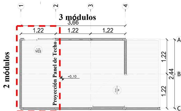
*Figura 1. Planta arquitectónica.*
