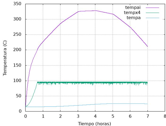
Figura 4: Temperatura interna del absorbedor (*tempai*), de salida (*tempx4*) y ambiente (*tempa*).
