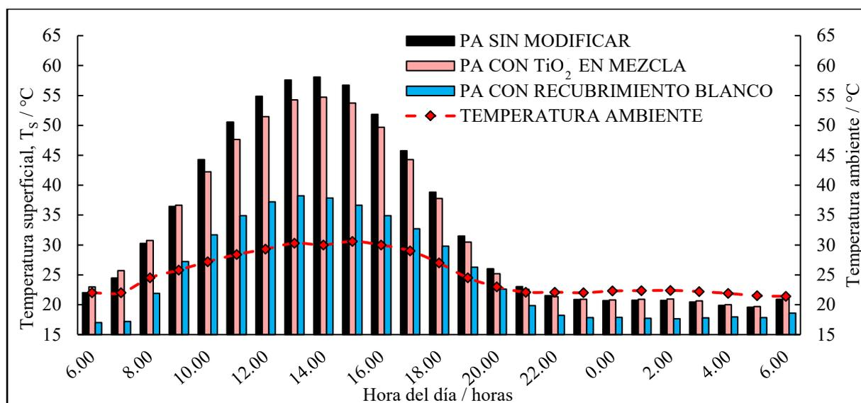
Figura 2a: Variación horaria de las temperaturas superficiales,  $T_s$ , de muestras de PA sin y con recubrimiento blanco o con  $\text{TiO}_2$  en su composición, todas expuestas un día completo al aire libre.
