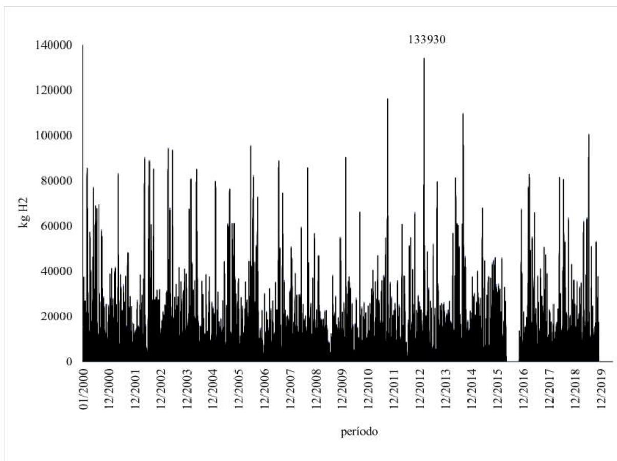
Figura 3: Simulación del tamaño mínimo necesario en kgH<sub>2</sub> que debe tener el acumulador, para la configuración 5 y 20% participación en la demanda, para el período 1/1/2000 al 31/12/2019. Fuente: Elaboración propia.
