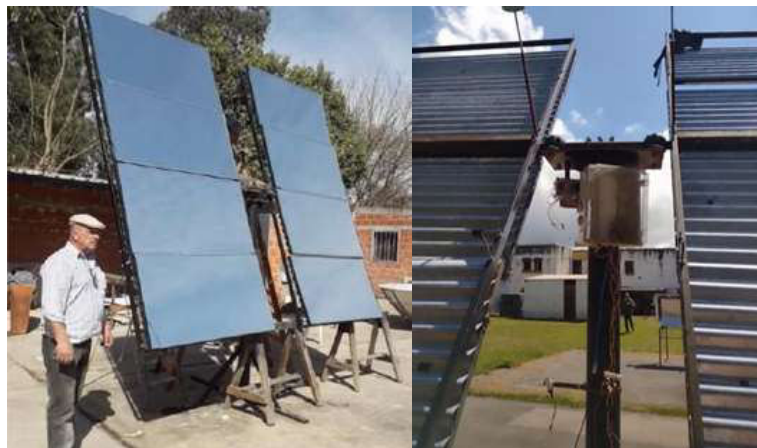
Figura 2: Estructura pedestal del primer prototipo de helióstato
