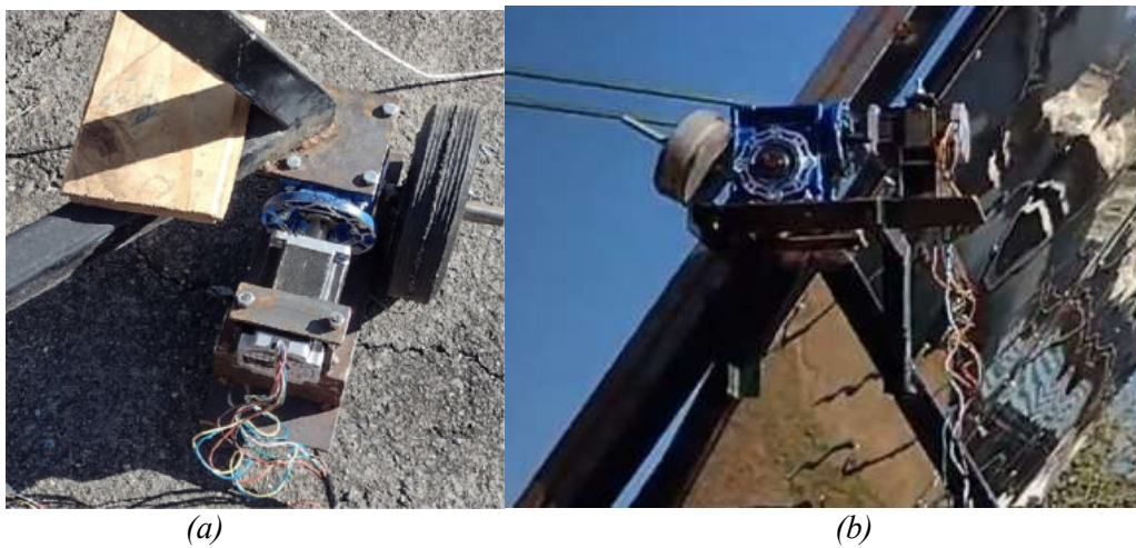
Figura 4: Motores para el movimiento azimutal (a) y de elevación (b)
