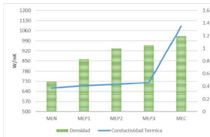
Figura 10: densidad y conductividad térmica de las dosificaciones.
