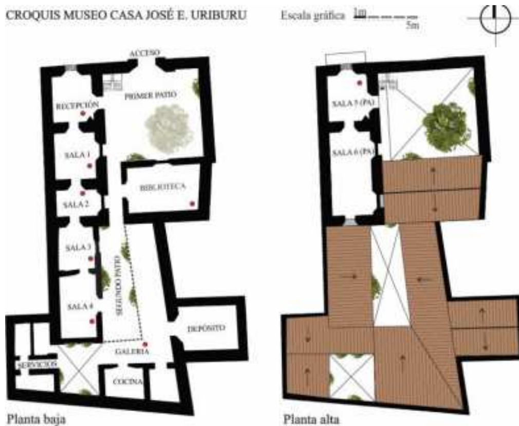
Figura 3: Croquis del Museo Planta Baja y Planta Alta. Los círculos rojos señalan la ubicación de los sensores de medición. Fuente: elaboración propia.
