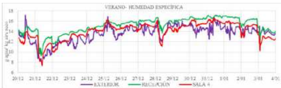
Figura 12: Contenido de humedad ambiente en verano. Fuente: elaboración propia.
