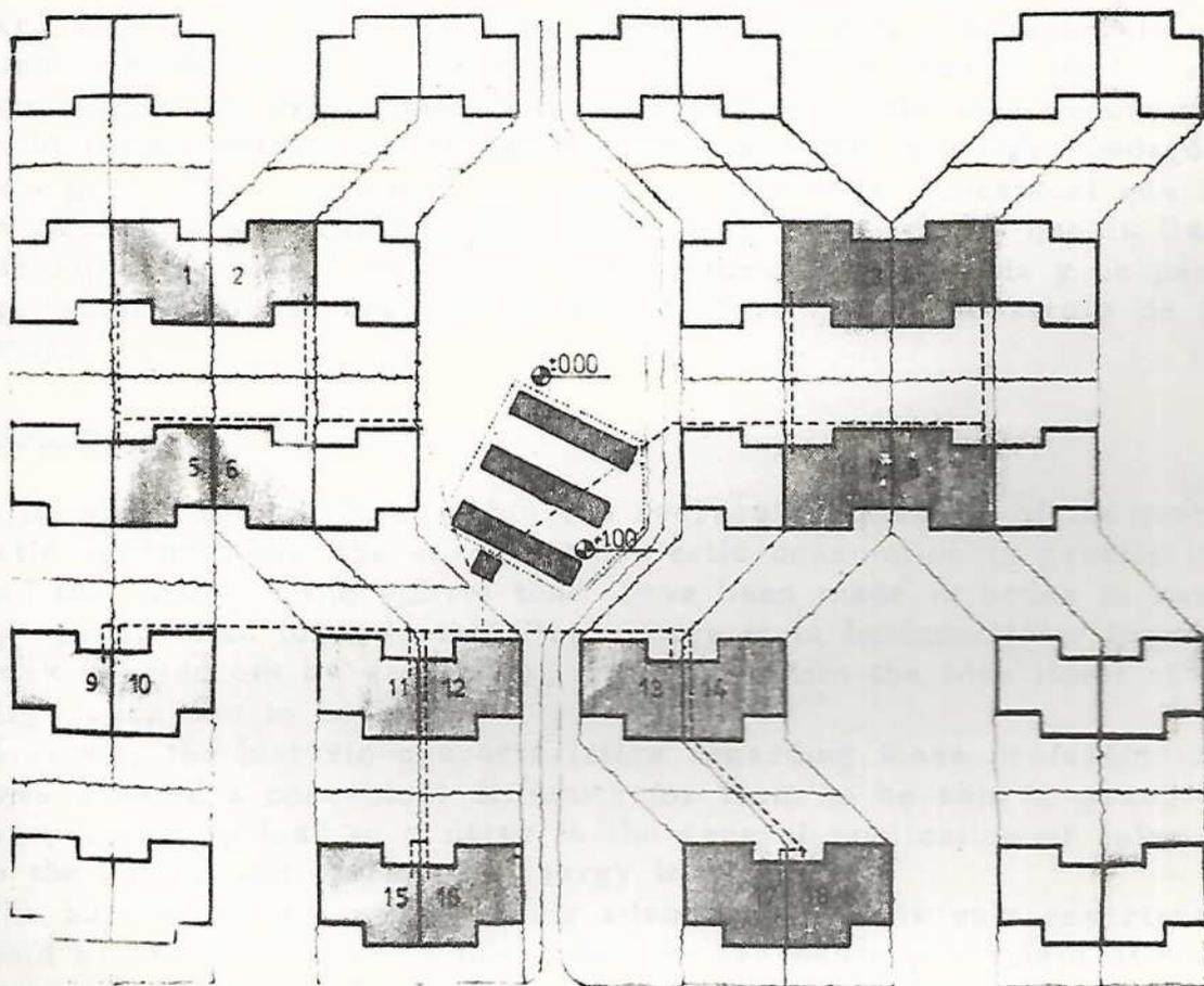
EL SISTEMA CENTRALIZADO DE PROVISION DE AGUA CALIENTE A UBICAR EN EL ESPACIO COMUN EQUIDISTANTE DE LAS 16 VIVIENDAS A SERVIR CONSTA DE 60M<sup>2</sup> DE SUPERFICIE COLECTORA UN TANQUE ACUMULADOR PARA 5000LS Y SU RED DE DISTRIBUCION
