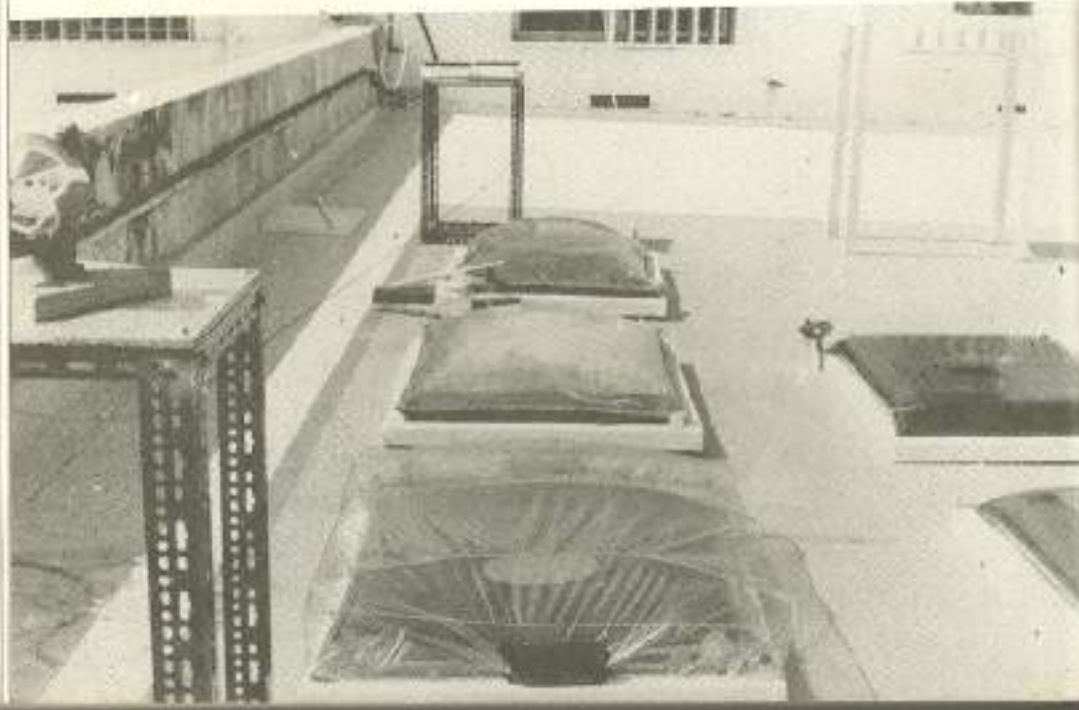
(I, 2) Modelos de estanques solares playos construidos con fines de ensayo de diferentes geometrías y materiales.
