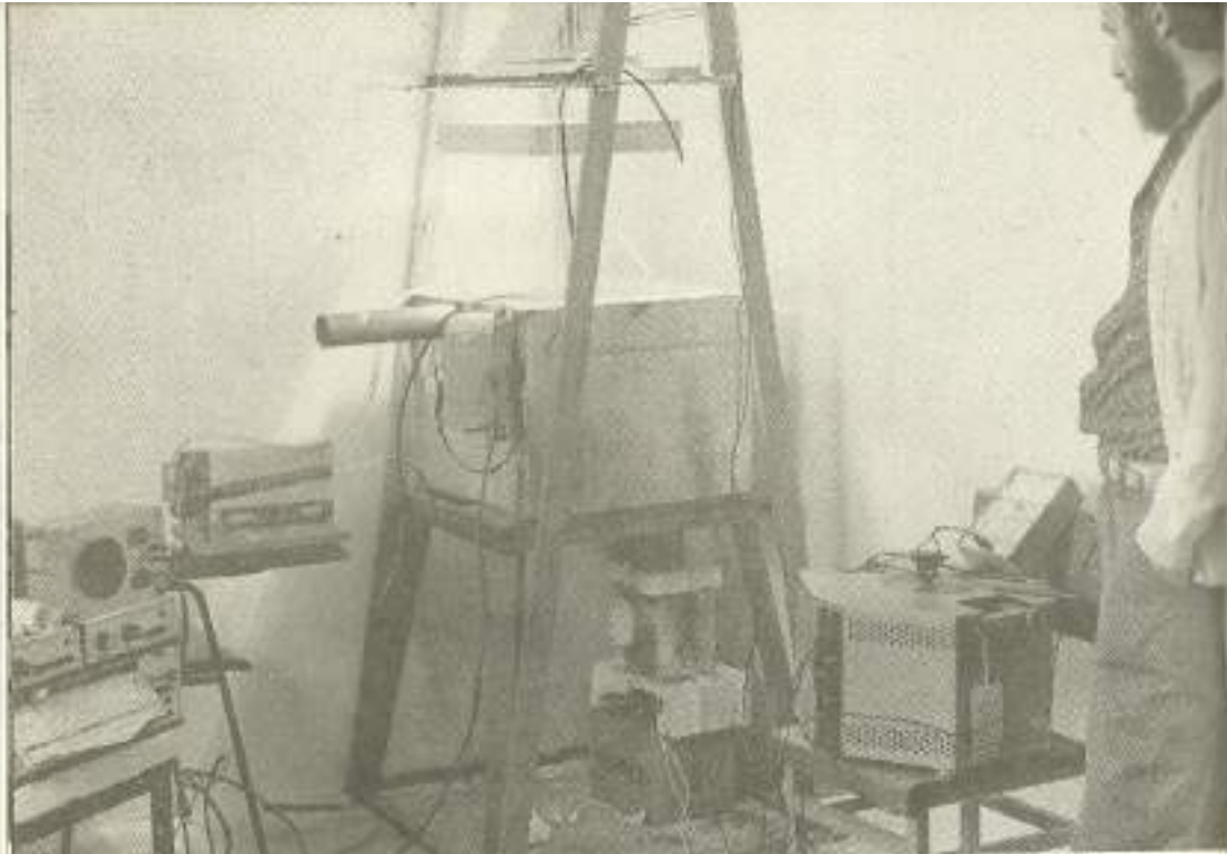
(IV. 2) Ensayo de matrices porosas para calentadores solares de aire.
