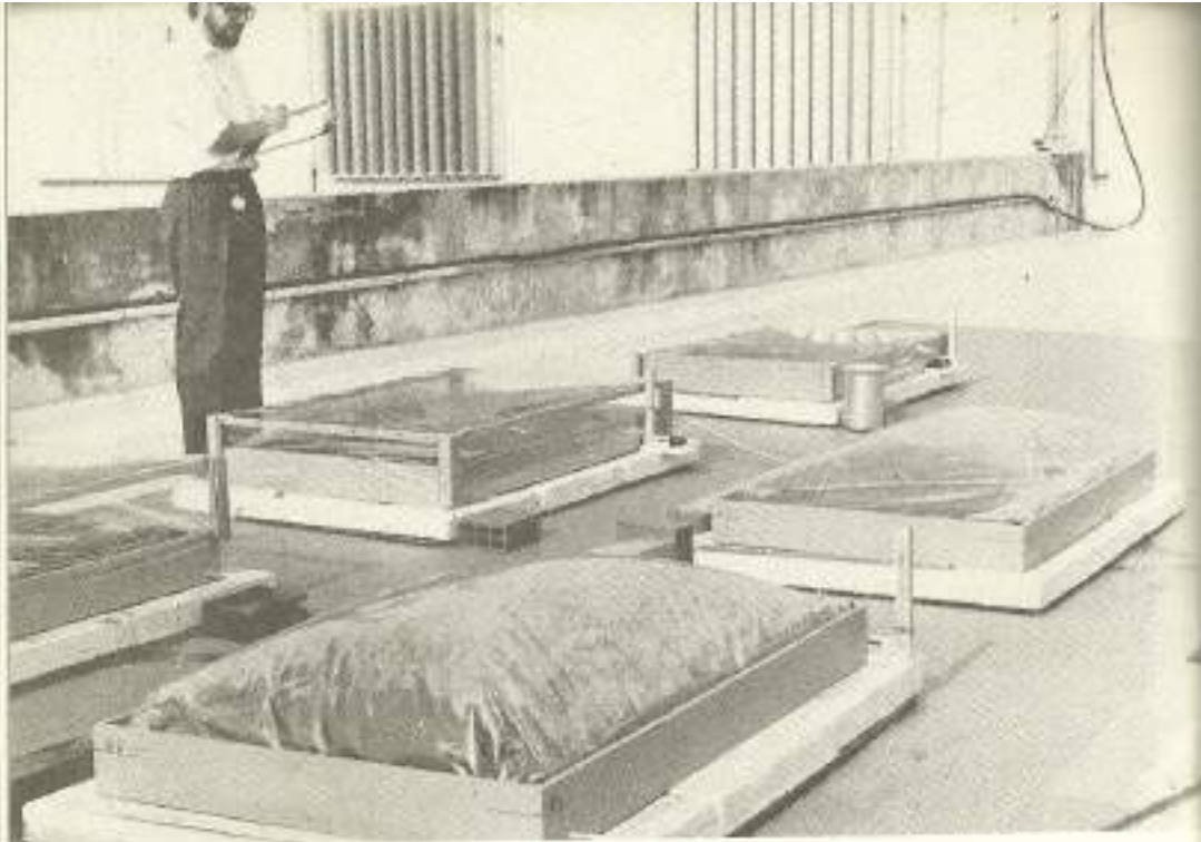
(I, 2) Modelos de estanques solares playos construidos con fines de ensayo de diferentes geometrías y materiales.
