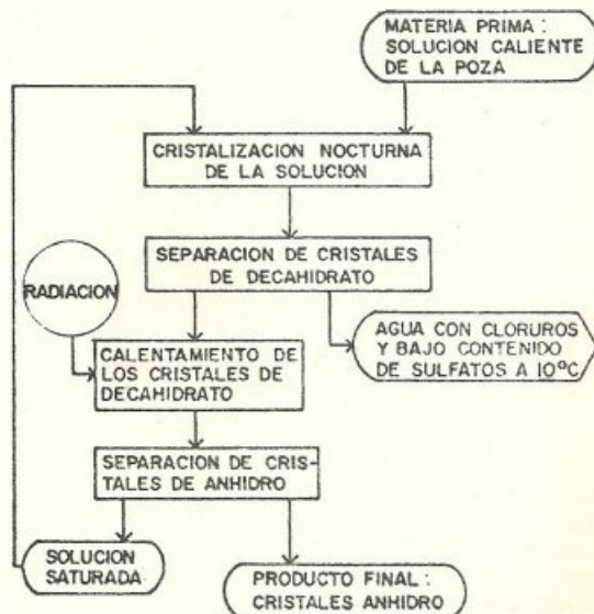
Fig. 2. Esquema del proceso de anhidración por cambio de fase.
