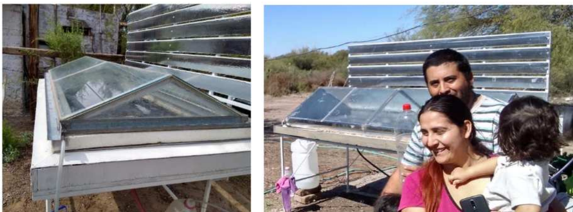
Figura 4: destilador solar de batea y la familia que recibe el destilador.
