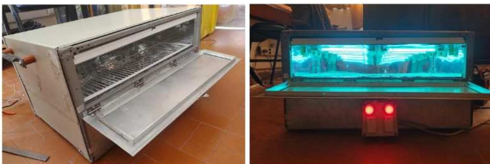
Figura 6: Vista en perspectiva de la cabina construida. Disposición superior de lámparas germicidas, teclas de encendido y luces indicativas de operación.
