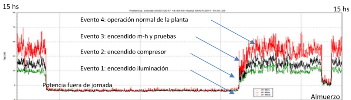
Figura 2: Registro de potencias registradas entre el 06/07/2017 y 07/07/2017 (salida de Fluke 1735)
