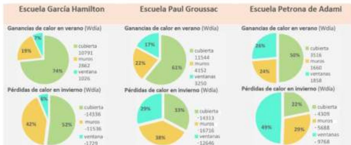
Figura 2: Carga térmica total a través de cada uno de los elementos de la envolvente de aulas prototípicas de escuelas de S.M. de Tucumán
