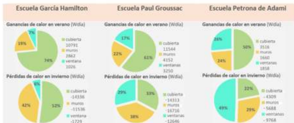
Figura 2: Carga térmica total a través de cada uno de los elementos de la envolvente de aulas prototípicas de escuelas de S.M. de Tucumán
