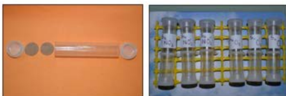
Figura 3. Detalles del muestreador pasivo construido según Palmes en el Laboratorio de Química Analítica de la Facultad de Ciencias Exactas de la UNSa y el conjunto a exponer
