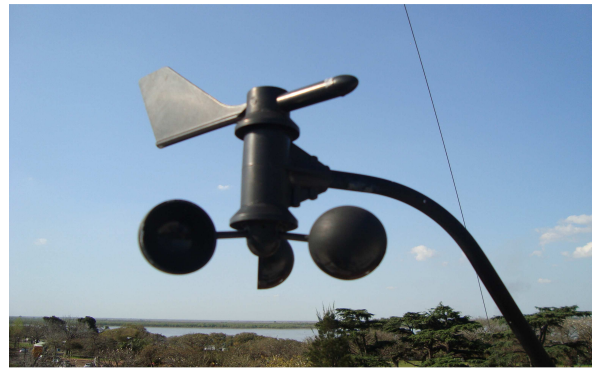
Figura 1: Vista panorámica del sitio de instalación de la estación meteorológica Davis cuyos datos son empleados para este trabajo, en el Observatorio y Planetario Municipal de la ciudad de Rosario (Izquierda). Vista ampliada de anemómetro y veleta (Derecha).
