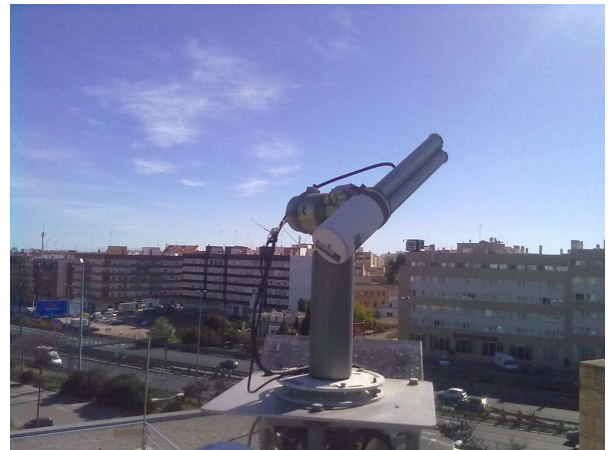
a) Figura 2a. Fotografía del sistema completo de adquisición de datos. Lo componen un espectroradiómetro LICOR Li-1800, un colimador y una notebook con puerto serie RS-232 DB25. 2b) Fotómetro solar CIMEL 318, de la estación AERONET sita en Valencia.
