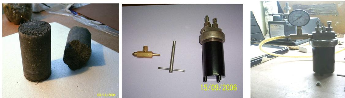
Figura N° 2: Briquetas fabricadas y Bomba calorimétrica de Malher utilizada para hallar el Poder calorífico de las muestras de briquetas
