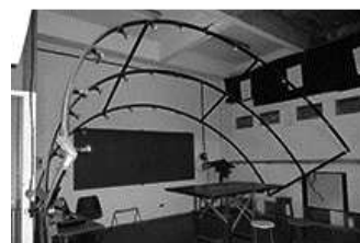
Figura 3: Heliodón utilizado para la evaluación del asoleamiento.
