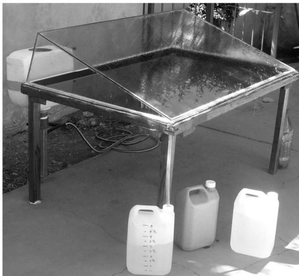
*Figura 1: Fotografía destilador solar utilizado actualmente.*
