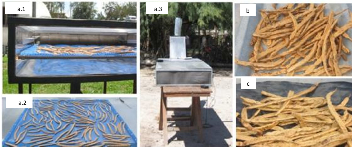
Figura 1. Métodos ensayados para el secado de los frutos de Prosopis alba , a.1 cámara de secado, a.2 bandeja, a.3 Secador solar, b. Secado sobre chapa de zinc, c. Secado sobre plástico negro.
