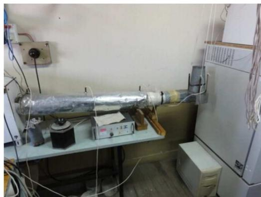
Figura 3 Ventilador centrífugo, selector de temperaturas y calentador de aire por resistencias.
