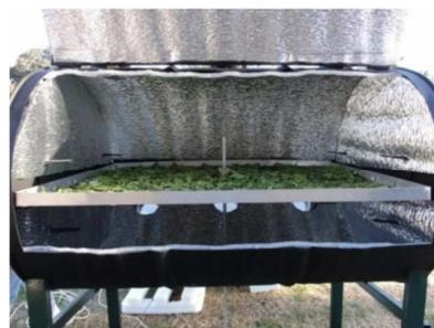
Figura 6 Cámara de secado y bandeja con el producto a secar.
