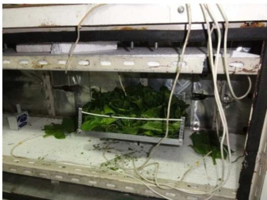
Figura 2 Cámara de secado, bandeja con el producto a secar y termocuplas.
