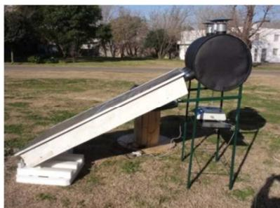
Figura 5 Vista lateral del deshidratador solar.
