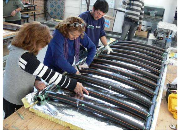
*Figura 6: Colocación de la parrilla del colector dentro del gabinete*
