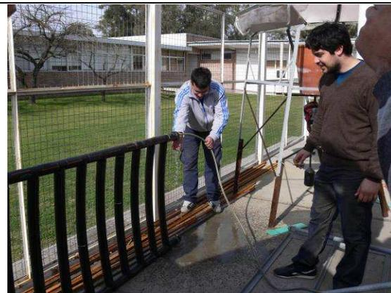
*Figura 7: Estudiantes realizando la prueba hidráulica de componentes*
