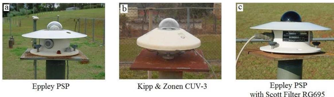
Figura 1: (a) piranometro PSP; (b) radiômetro CUV-3 Kipp y Zonen; (c) piranômetro PSP com cúpula seletiva.
