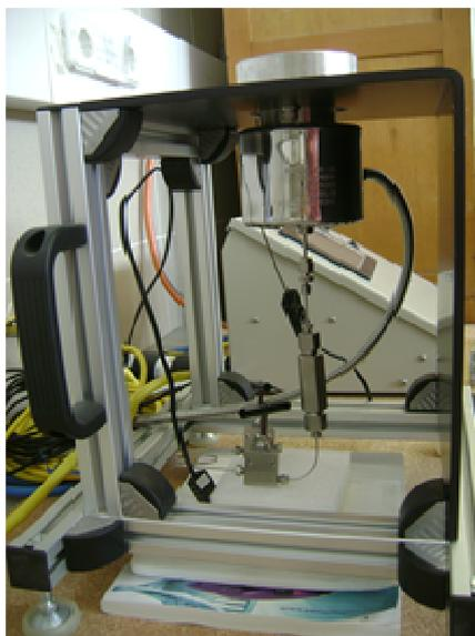
*Figura 1: Vista lateral del reactor batch de alta presión (HPR-Series High Pressure Chemical Reactor). En un segundo plano puede observarse el equipo para el control y monitoreo de temperatura y administración de la rampa de calentamiento.*
