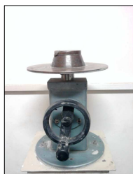
Figura 6: Dispositivo para el ensayo de consistencia, Flow Table.
