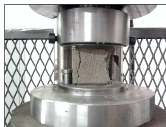
Figuras 8 y 9: Ensayo a compresión, dispositivo compuesto por prensa y celda de carga (izquierda) y tipo de rotura (derecha)
