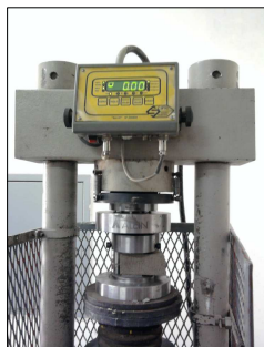
Figuras 8 y 9: Ensayo a compresión, dispositivo compuesto por prensa y celda de carga (izquierda) y tipo de rotura (derecha)
