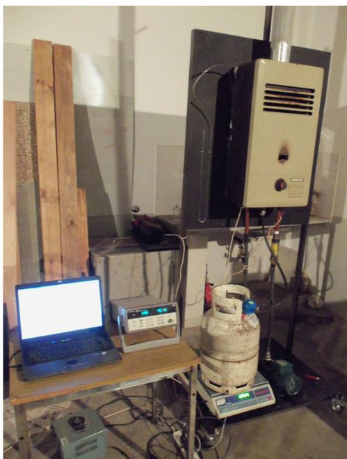
Figura 3 (a): Experimento realizado para determinar el rendimiento térmico del calefón.
