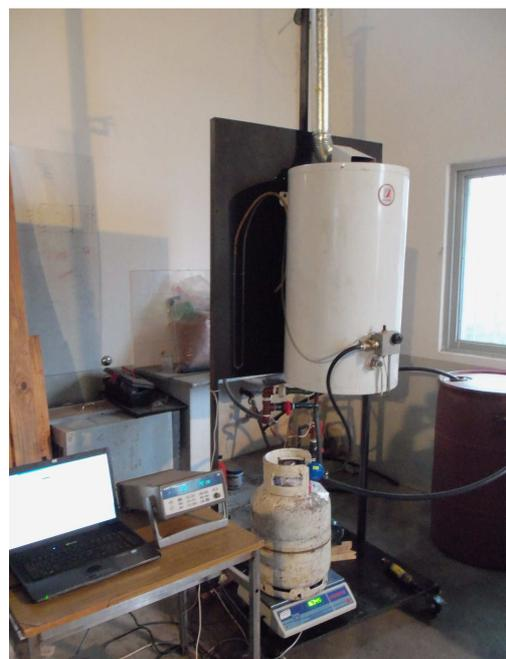
Figura 3 (b): Experimento realizado para determinar el rendimiento térmico del termotanque.
