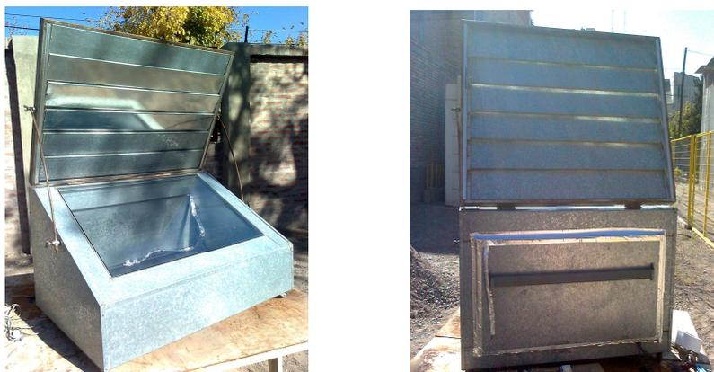
Figura 2: Vista frontal y posterior con puerta burleteada incluyendo rama con sensores.
