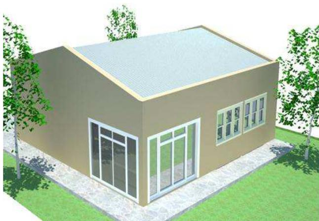
Figura 6: Perspectiva del modelo "hogares casa" simulado mediante el programa Energy Plus a los efectos de calcular su comportamiento energético en distintas condiciones.
