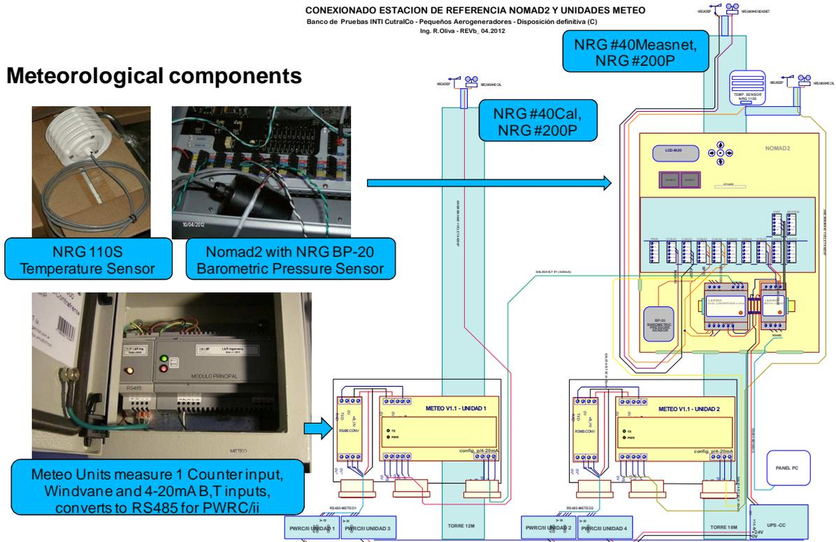
Figura 4 – Distribución del subsistema de datos meteorológicos con unidades Meteo y Unidad Nomad2 de Secondwind.
