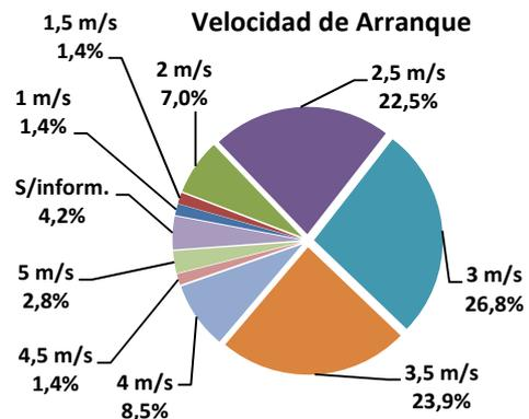
Figura 3: velocidad de arranque en los pequeños aerogeneradores eólicos relevados.
