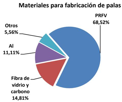
Figura 6: Materiales utilizados para la fabricación de aspas sobre 54 equipos analizados.
