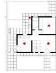
Figura 8c: Plano de ubicación de los sensores en la planta baja y exterior
