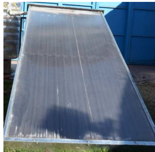
Figura 3. Fotografía del colector con la cubierta de policarbonato
